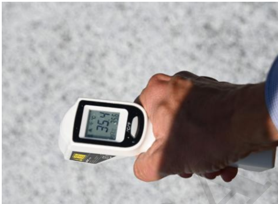
Prise de température au sol au moyen d'un thermomètre infrarouge ValoChem
